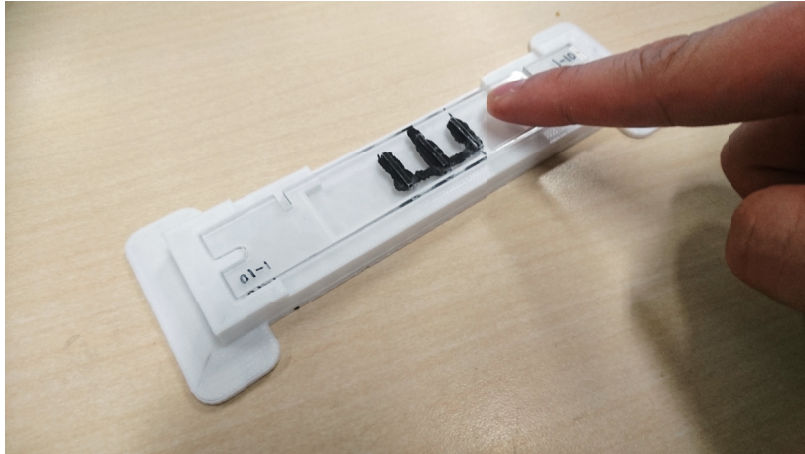
図 4.14: 電極を固定するための土台
