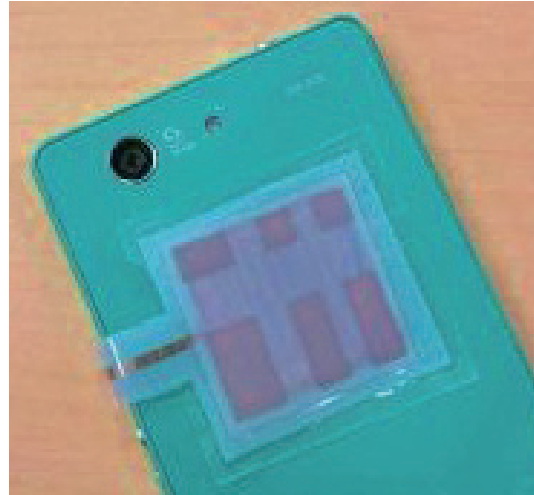
図 3.22: 導電インクを用いて印刷した電極
