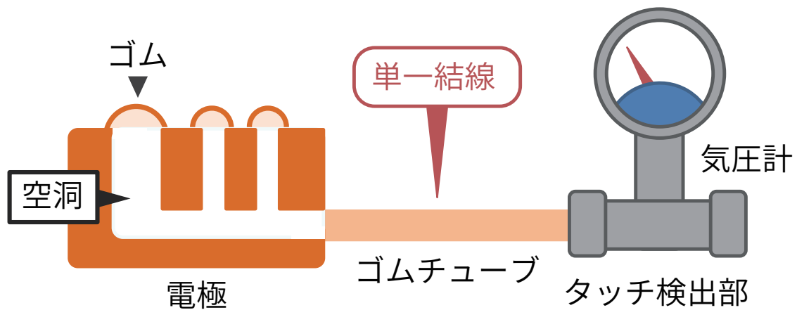
図 6.6: 気圧方式タッチ検出手法を用いたタッチジェスチャ認識用システム
